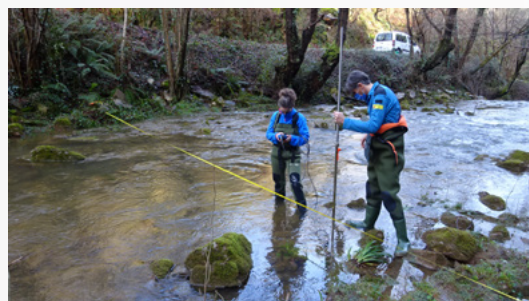
IMAGEN 14. Personal de la CH Cantábrico realizando un aforo para controlar una captación de agua. Fuente: fondo documental del Organismo.
